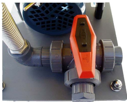
Клапан в положении DUMP (СЛИВ)
