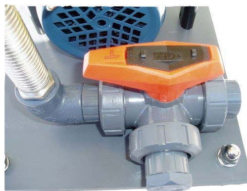
Клапан в положении CIRCULATION (ЦИРКУЛЯЦИЯ)
